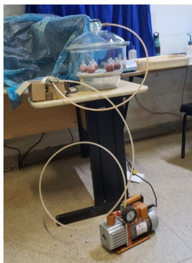
Figura 10 – Processo da retirada do ar dos balões volumétricos
