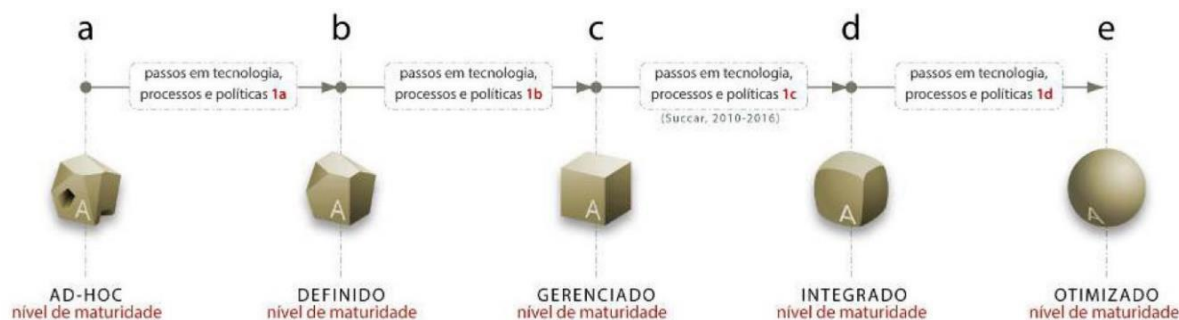
Figura 11 - Níveis de maturidade BIM - BIM EXCELLENCY INITIATIVE. 301in.PT Matriz de Maturidade BIM. Tradução de Prof. Dr. Leonardo Manzione
