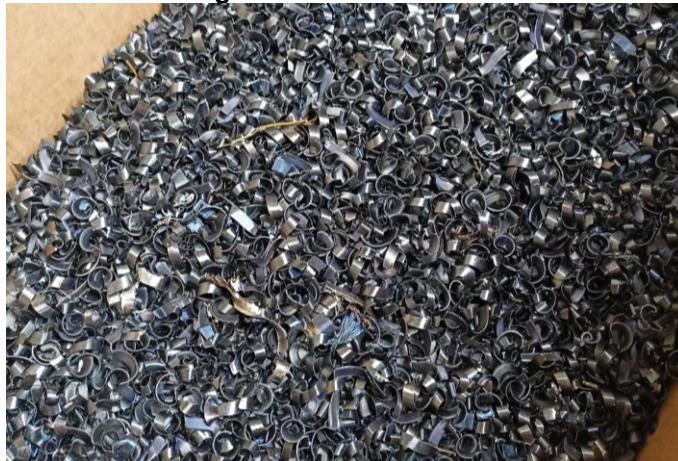
Fotografia 3 - Cavaco em arco
