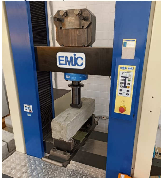
Fotografia 5 - Máquina universal de ensaio EMIC
