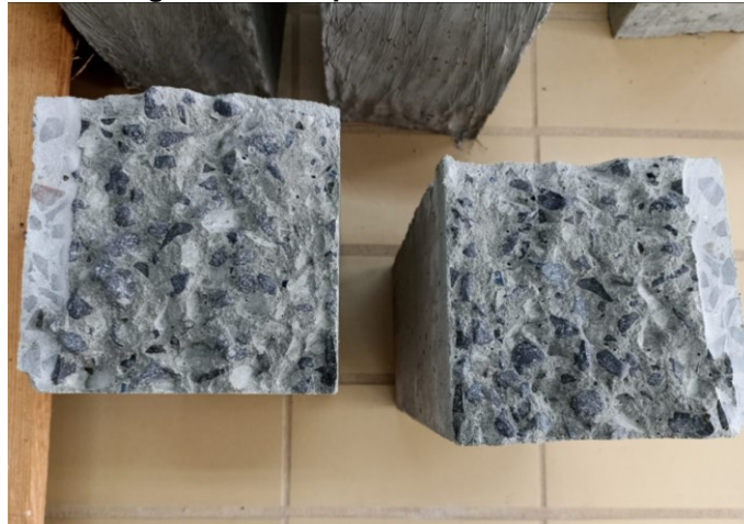
Fotografia 15 - Ruptura do cavaco em arco
