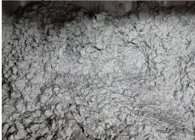
Fotografia 8 - Dispersão das fibras de aço
