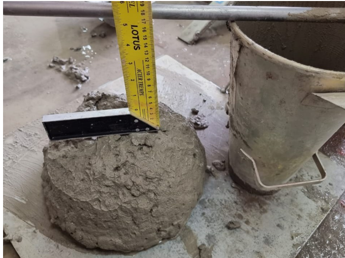
Fotografia 11 - Abatimento do tronco de cone com o cavaco em arco
