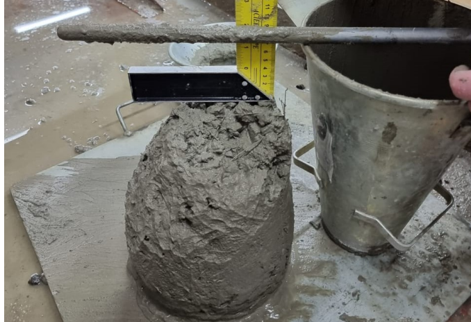
Fotografia 10 - Abatimento do tronco de cone com a fibra de aço
