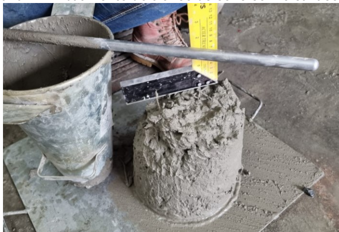
Fotografia 12 - Abatimento do tronco de cone com o cavaco tubular
