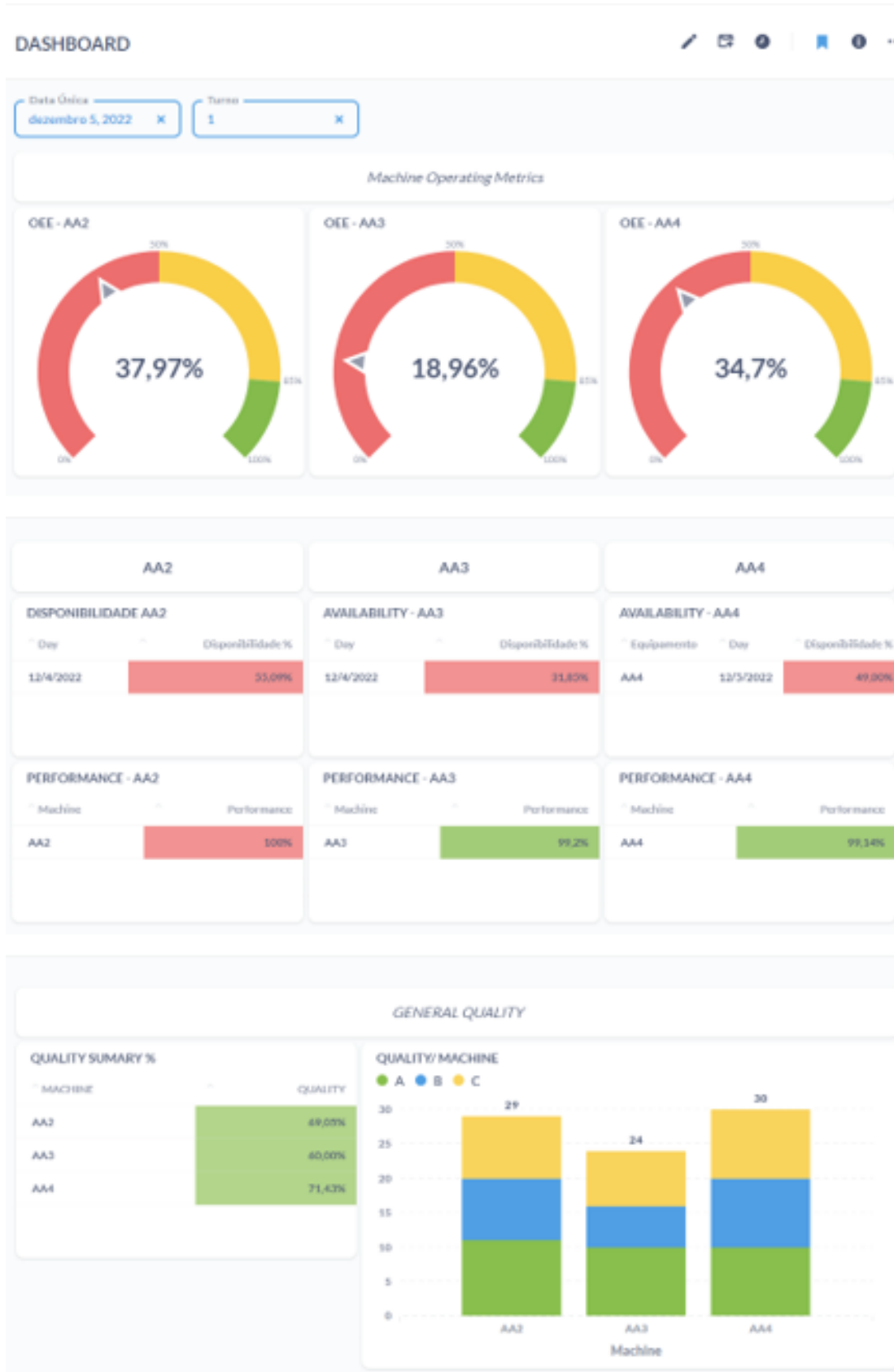
Figura 41: Dashboard final baseado da arquitetura OEE digital
