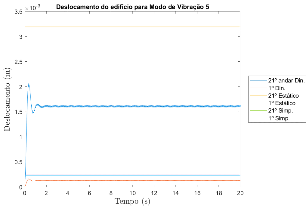
Figura 25 - Deslocamentos do edifício - comparação entre método (1), (2) e (3) com frequência de excitação f=12,138 Hz.
