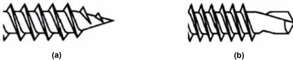
Figura 5 - Tipos de pontas de parafusos utilizados no LSF.
