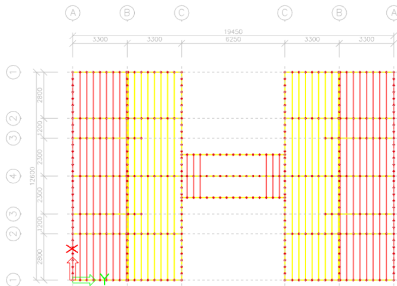
Figura 25 - Lançamento das vigas.
