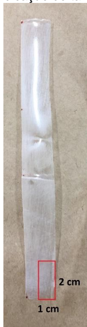
Figura 5- Tira de garrafa PET com indicação do tamanho e local da retirada de amostras
