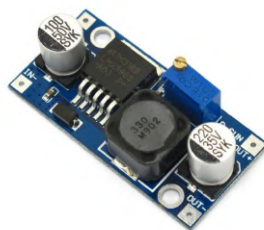
Figura 10 – Regulador de tensão LM2596
