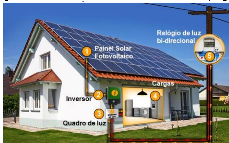
Figura 11 – Sistema solar fotovoltaico conectado à rede ( on-grid )
