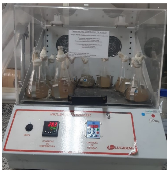
Figura 11 - Sistema experimental batelada utilizado no enriquecimento de bactérias oxidadoras de nitrito
