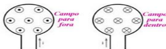
Figura 23: Representação esquemática do campo magnético no interior da espira.
