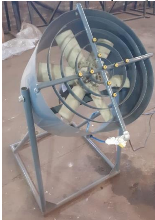
Figura 10 - Ventilador com sistema de pulverização de água
