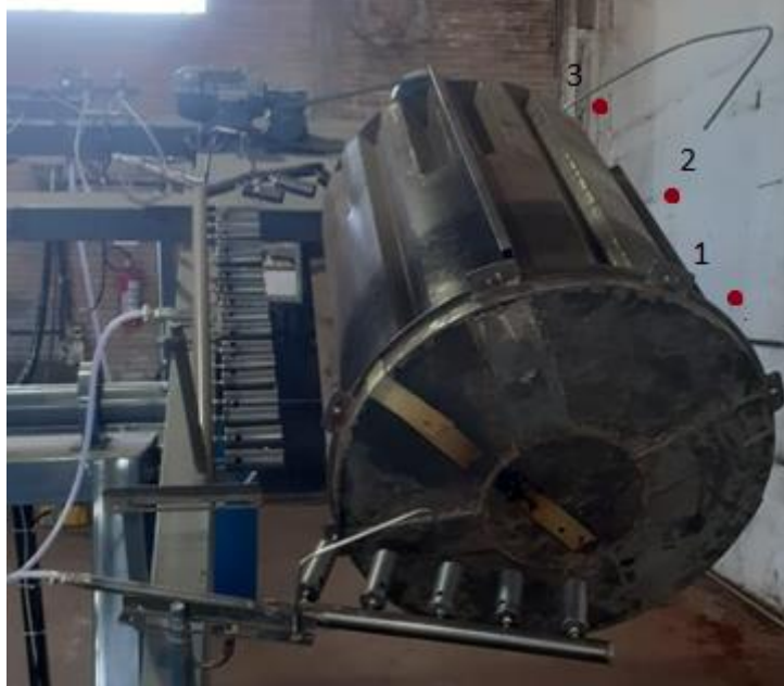
Figura 33 - Molde com pontos de tomada de temperatura
