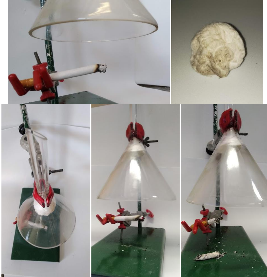
Figura 36 - Aparato experimental utilizado para coletar fumaça de cigarro
