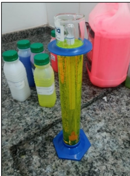
Figura 18 – Instrumento utilizado para a medição da densidade das amostras.
