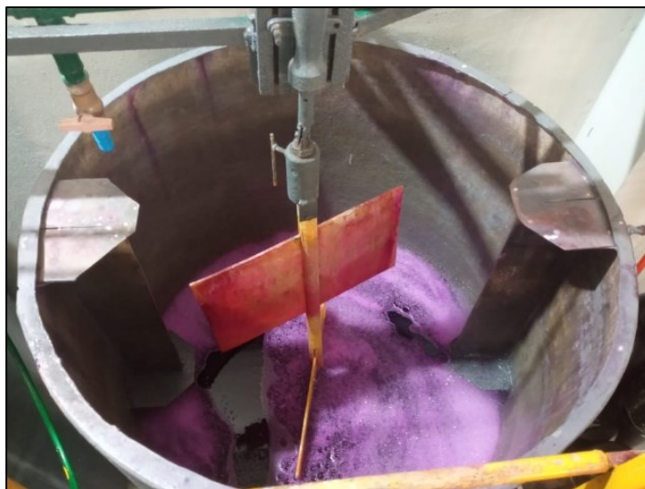
Figura 21 –Tanque 1 contendo duas chicanas e um eixo impelidor com três impelidores do tipo pás retas em forma de folha.
