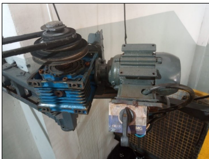
Figura 23 – Motor utilizado para a agitação acoplado a uma caixa de redução.
