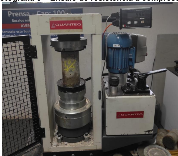
Fotografia 5 – Ensaio de resistência a compressão
