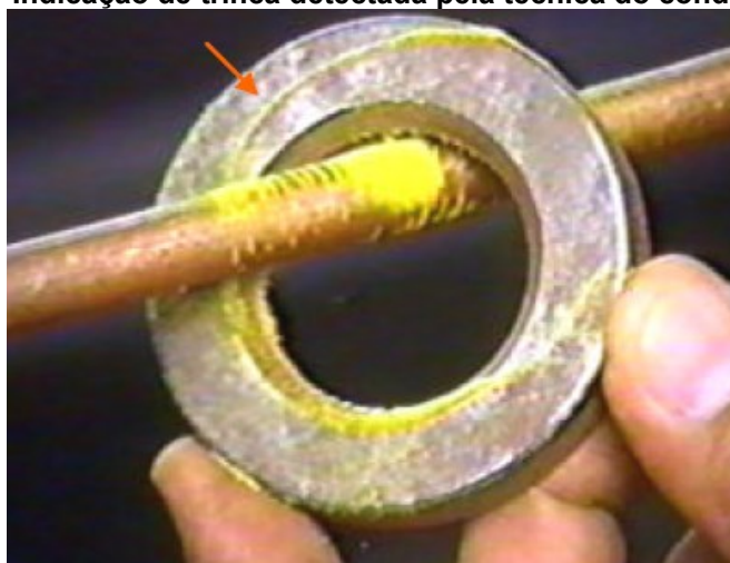
Figura 61 - Indicação de trinca detectada pela técnica do condutor central
