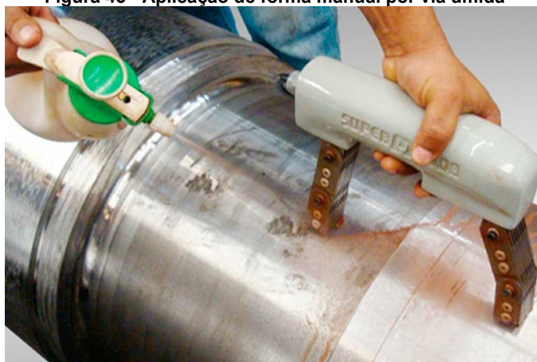
Figura 45 - Aplicação de forma manual por via úmida
