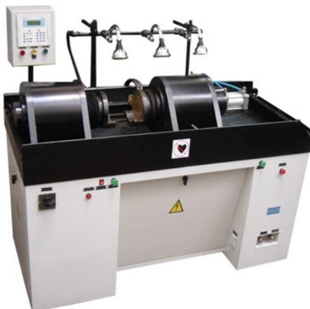
Figura 48 - Equipamento estacionário horizontal para utilizado para aplicação da técnica de ensaio por magnetização circular direta
