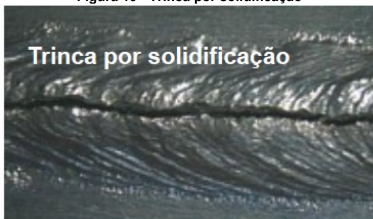
Figura 19 - Trinca por solidificação
