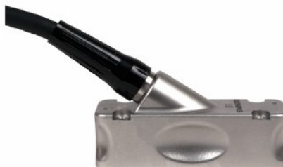
Figura 70 - Transdutor tipo phased array com 60 cristais, da marca Olympus
