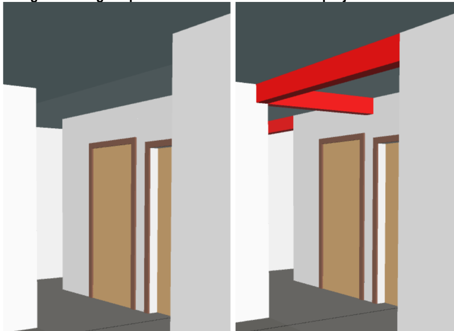
Figura 23: Vigas aparentes não consideradas em projeto no ambiente 9
