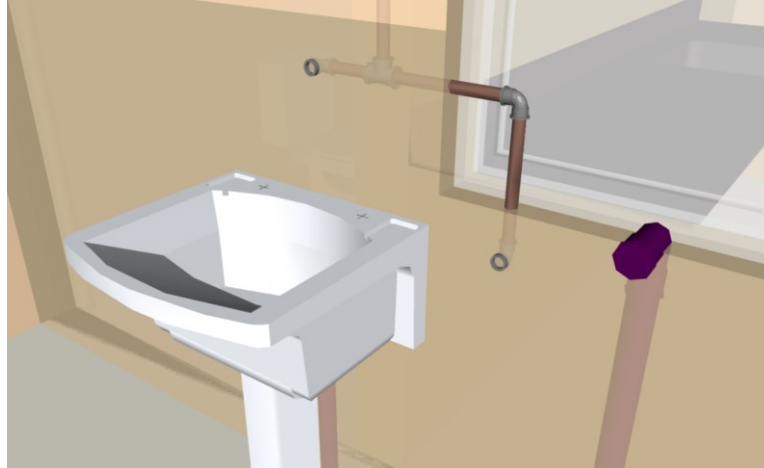
Figura 27: Interferência tubulação de água fria e de esgoto com janela
