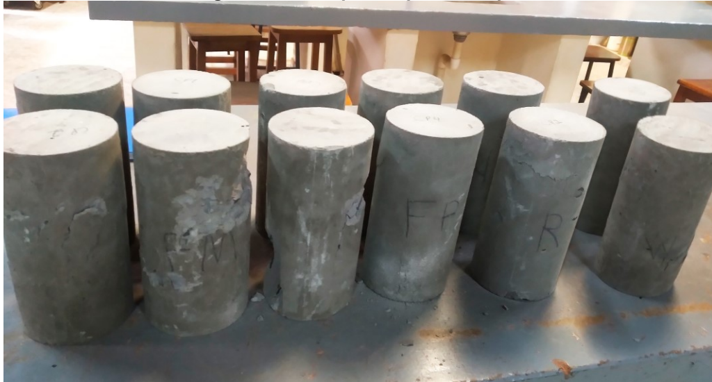
Fotografia 17 – Corpos de prova rompidos
