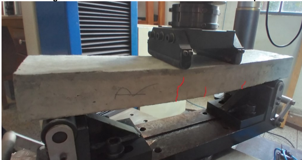
Fotografia 18 – Placa de concreto com tela metálica rompida
