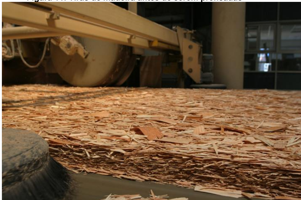
Figura 11: Tiras de madeira antes de serem prensadas
