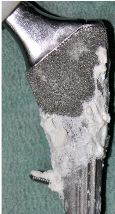
Figura 1 – Crescimento ósseo sobre a superfície porosa de um componente femoral de titânio
