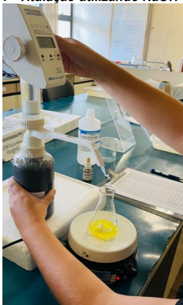
Figura 14 - Titulação utilizando NaOH 0,1 mol/L
