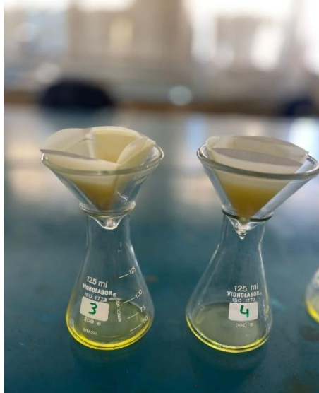
Figura 12 - Filtração com papel de filtro quantitativo
