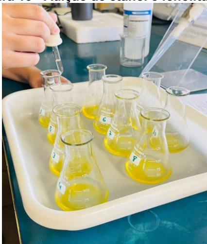
Figura 13 - Adição de etanol e fenolftaleína
