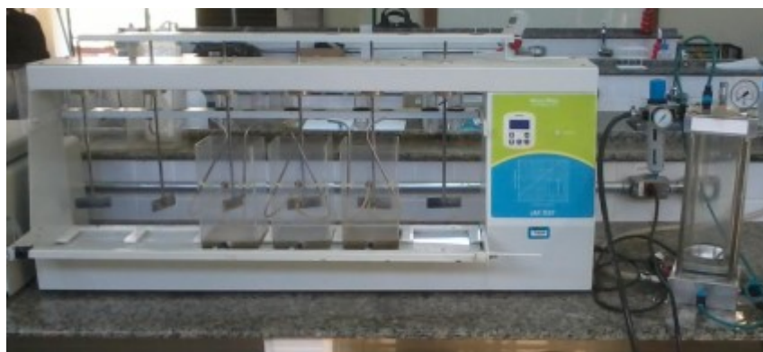
Figura 5: Flotest com 3 jarros montado na bancada do laboratório de saneamento
