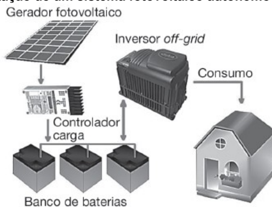
Figura 1 - Representação de um sistema fotovoltaico autônomo e seus componentes
