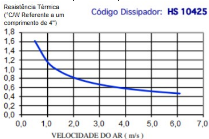
Figura 19 - Curva Resistência Térmica em relação a Velocidade do ar para o dissipador
