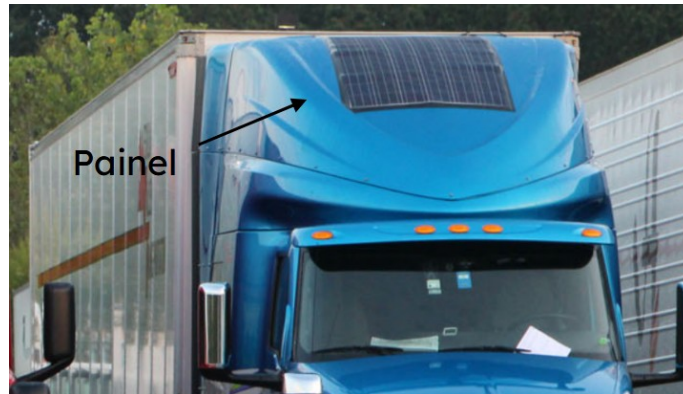
Figura 12 - Painel solar do tipo filme fino instalado no defletor de ar de um caminhão
