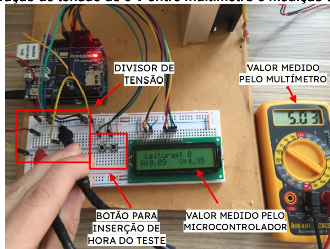
Figura 27 - Comparação de tensão de 5 V entre multímetro e medição do microcontrolador
