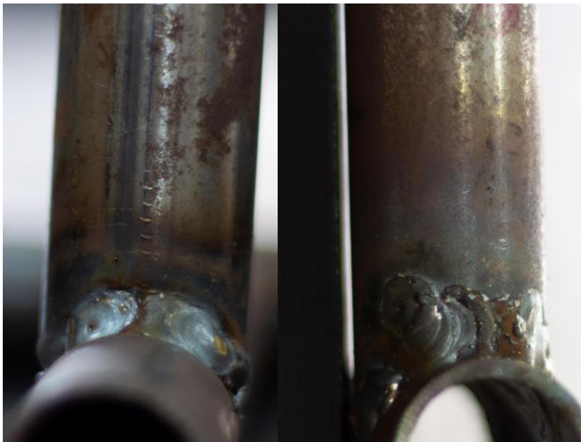
Figura 7: Comparação do comprimento da ZTA nos encaixes da Figura 6.
