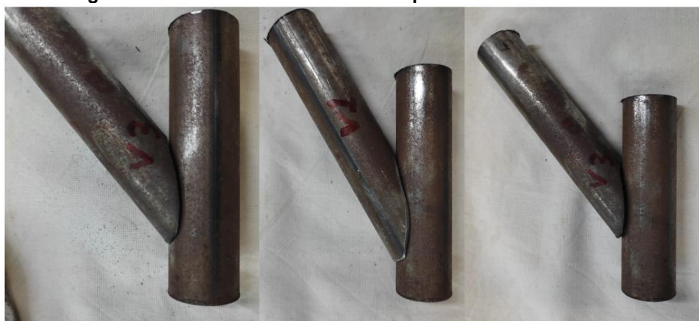
Figura 23: Encaixe das bocas de lobo pelo método tradicional 30°.
