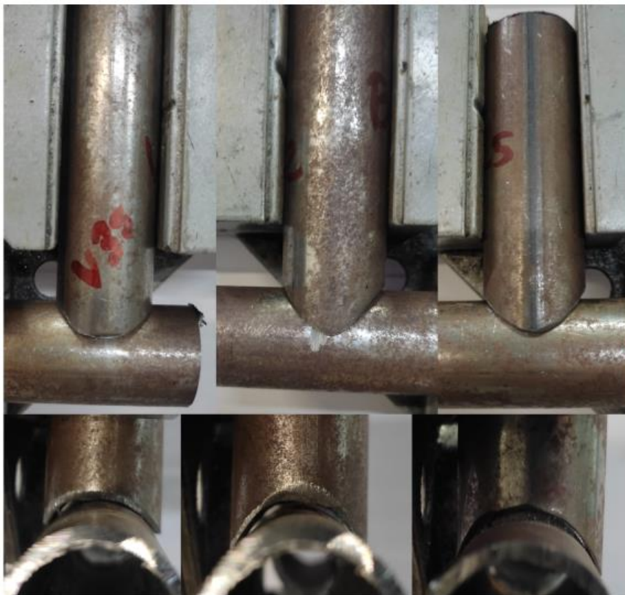
Figura 22: Encaixe das bocas de lobo pelo método tradicional 90°.
