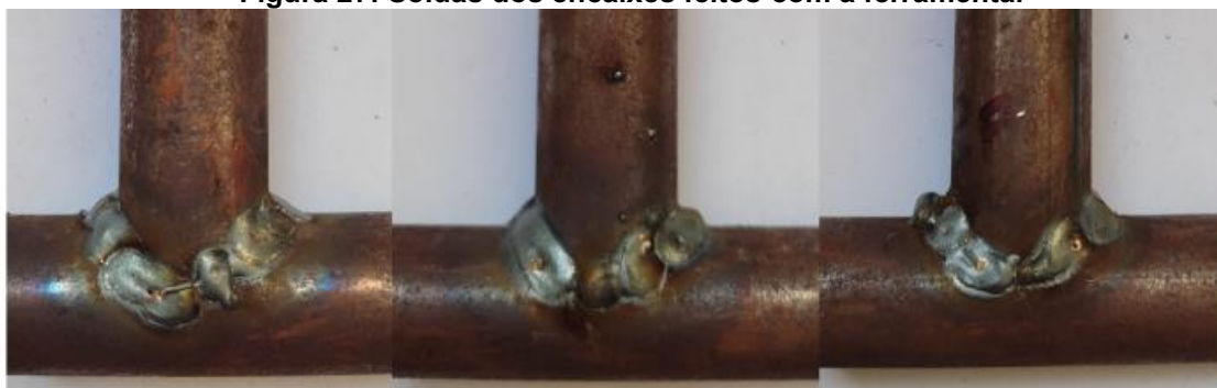
Figura 27: Soldas dos encaixes feitos com a ferramenta.
