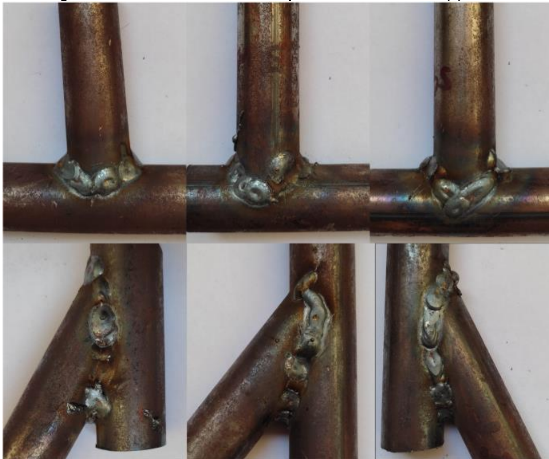
Figura 24: Soldas dos encaixes feitos pelo método tradicional. (a) solda rea
