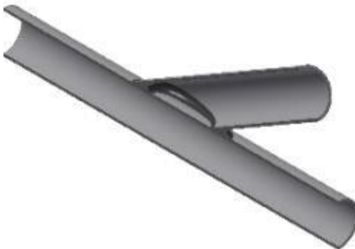
Figura 3: Amostra com corte para visualização de penetração da solda.
