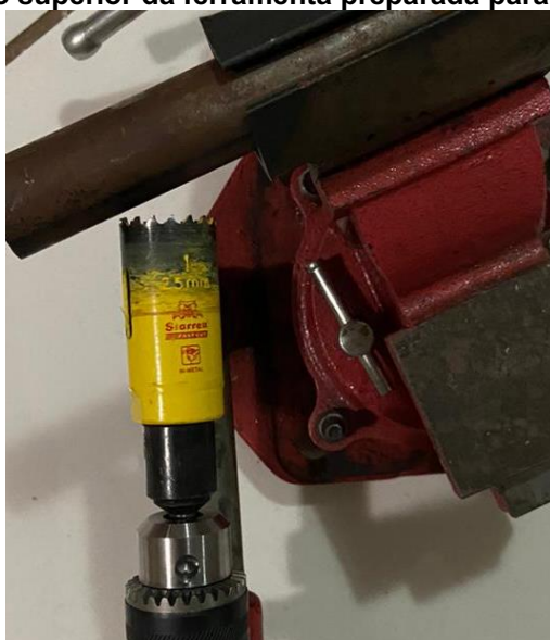
Figura 28: Visão superior da ferramenta preparada para corte em ângulo
