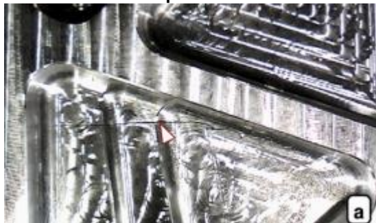
Figura 15 – Uma trinca aparecendo na amostra AFL 7050-T7451 com P_{max} = 158 kN. A seta indica o ponto de início
