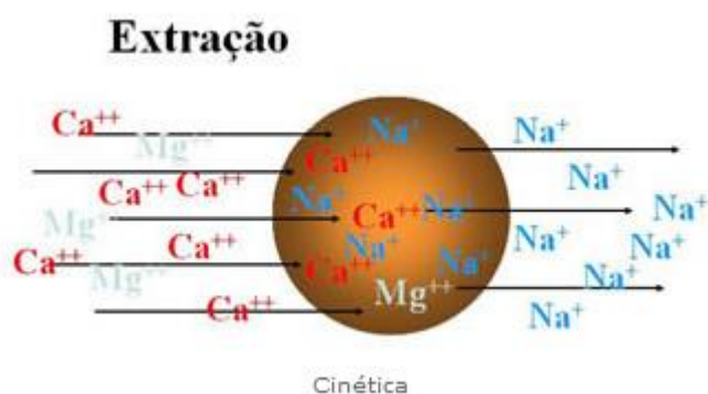
Figura 6 - Mecanismo de remoção de \text{Ca}^{+2} da resina catiônica na forma sódica.
