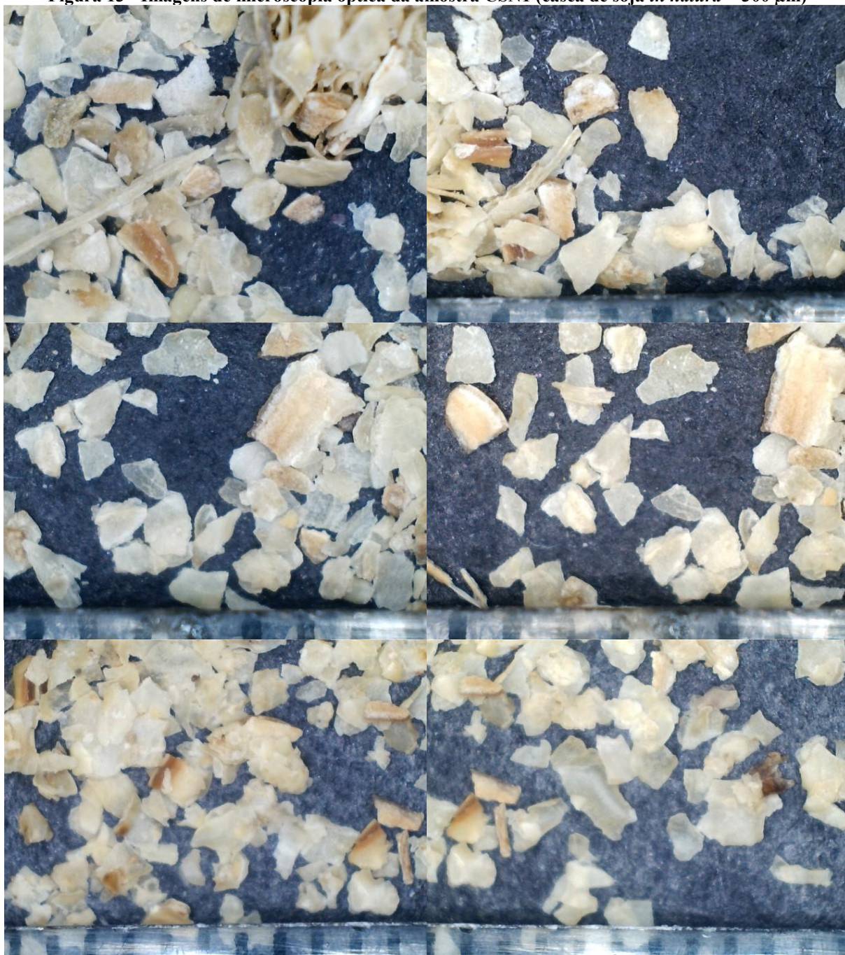
Figura 13 - Imagens de microscopia óptica da amostra CSN1 (casca de soja in natura > 300 \mu\text{m} )
