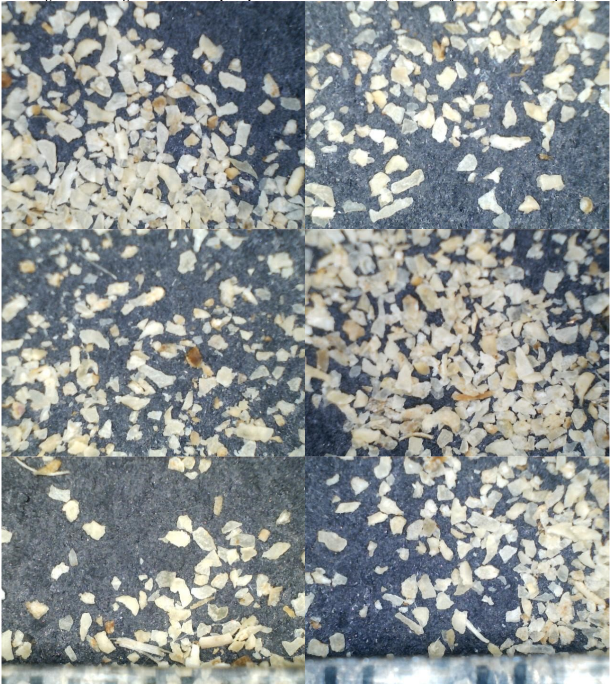
Figura 14 - Imagens de microscopia óptica da amostra CSN2 (casca de soja in natura > 300 \mu\text{m} )
