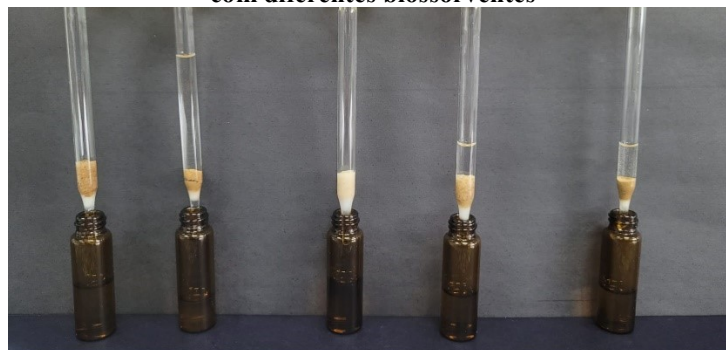
Figura 34 - Registro fotográfico do processo de percolação de solução de estradiol em coluna empacotada com diferentes biossorventes
