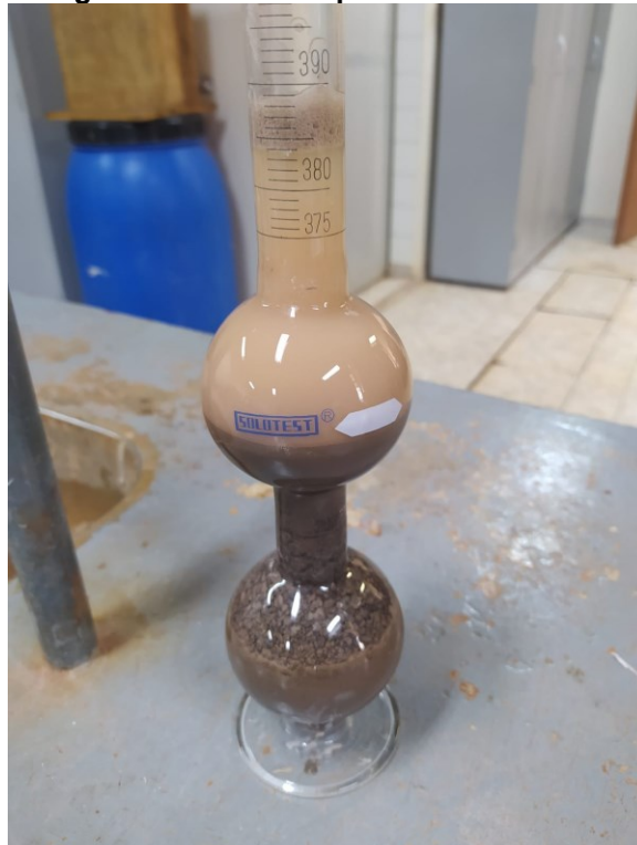
Fotografia 3 - Massa específica areia artificial
