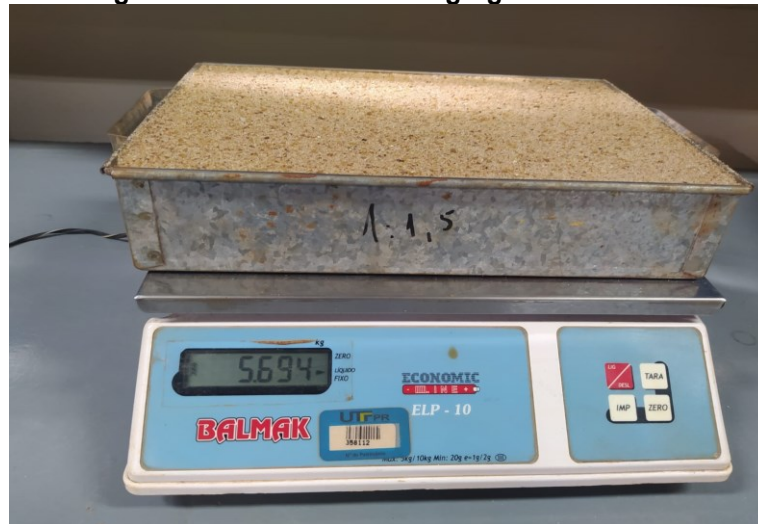
Fotografia 4 – Massa unitária agregado Areia Natural
