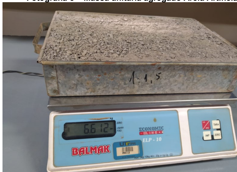
Fotografia 5 – Massa unitária agregado Areia Artificial
