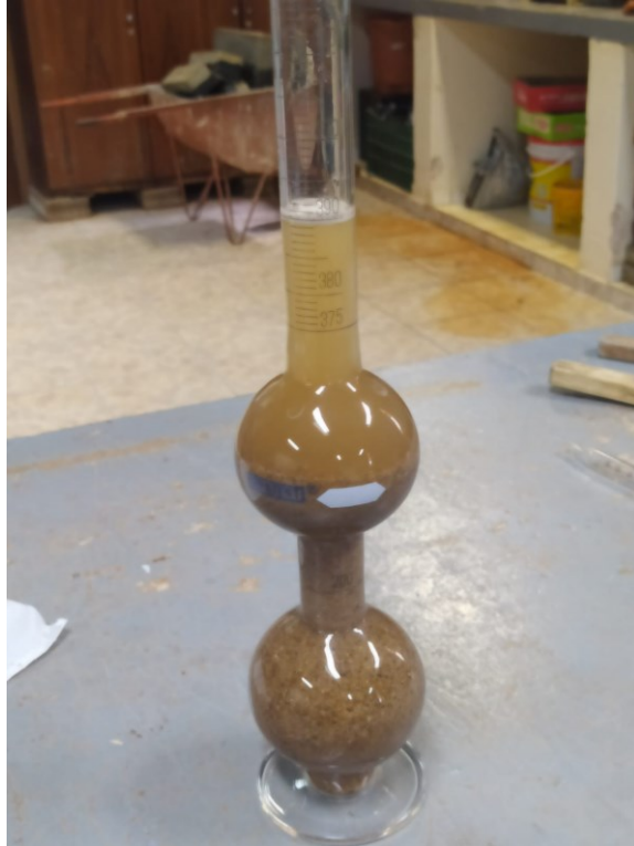
Fotografia 2 - Massa específica da Areia Natural
