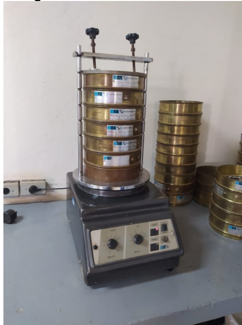
Fotografia 1 - Ensaio de Granulometria
