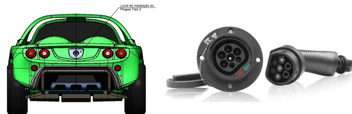
Figura 17 – Localização do plugue Tipo 2 na traseira do bugue elétrico para a recarga da bateria.
