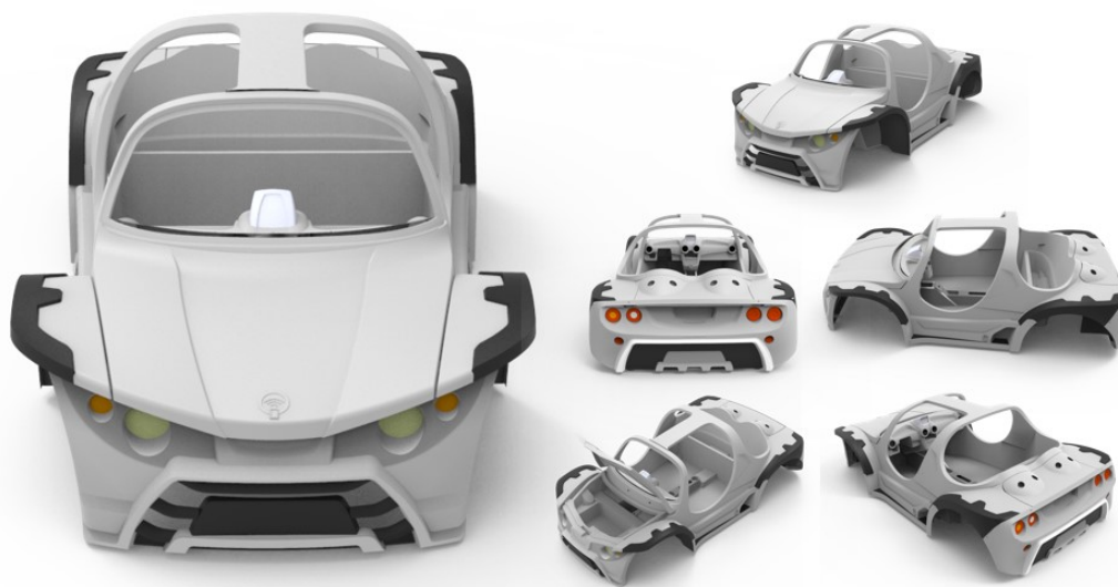
Figura 22 – Imagens do modelo 3D do Protótipo Beta com o novo design do bugue 100% elétrico viabilizado pelo autor, e, principalmente, com a sua frente inspirada nas tradicionais carrancas que remetem à segurança, força e bravura.
