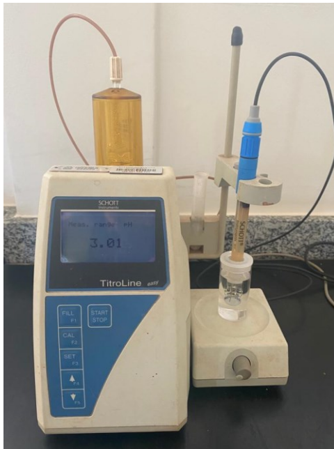
Figura 19 - Potenciômetro da marca Schott Instruments e modelo TitroLine easy e eletrodo combinado de vidro da marca Schott Instruments e modelo A7780.
