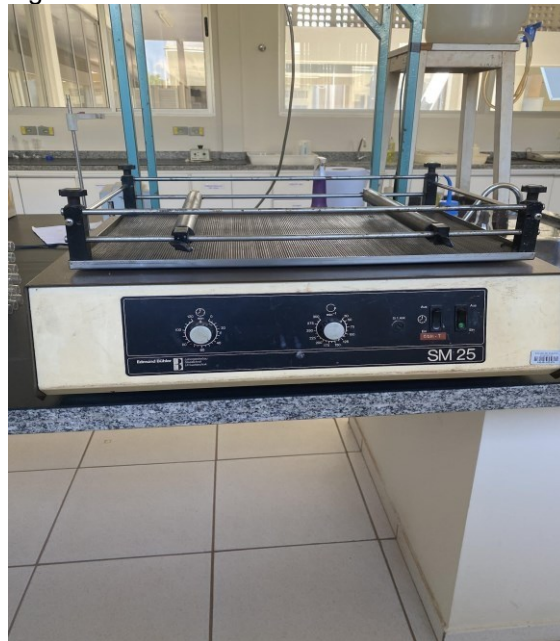
Figura 20 - Agitador orbital da marca Edmund Bühler e modelo SM25.
