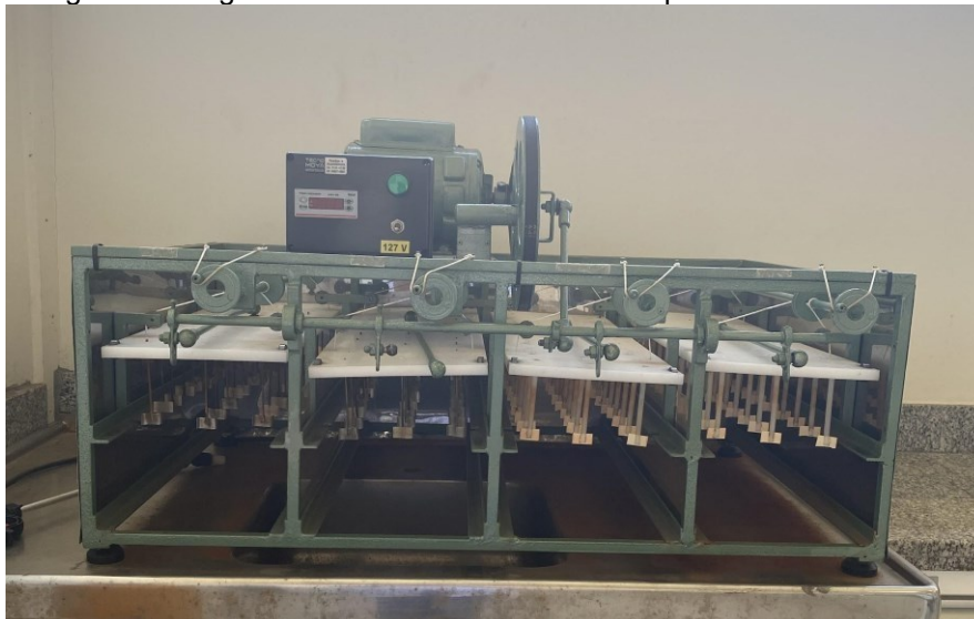
Figura 16 – Agitador mecânico da marca Inova para amostra de solo.
