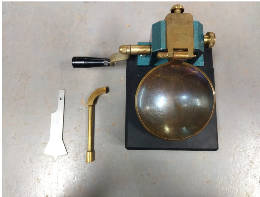
Fotografia 14 – Aparelho de Casagrande e cinzel
