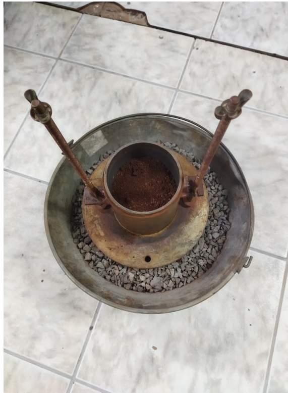
Fotografia 22 – Compactação dentro do molde
