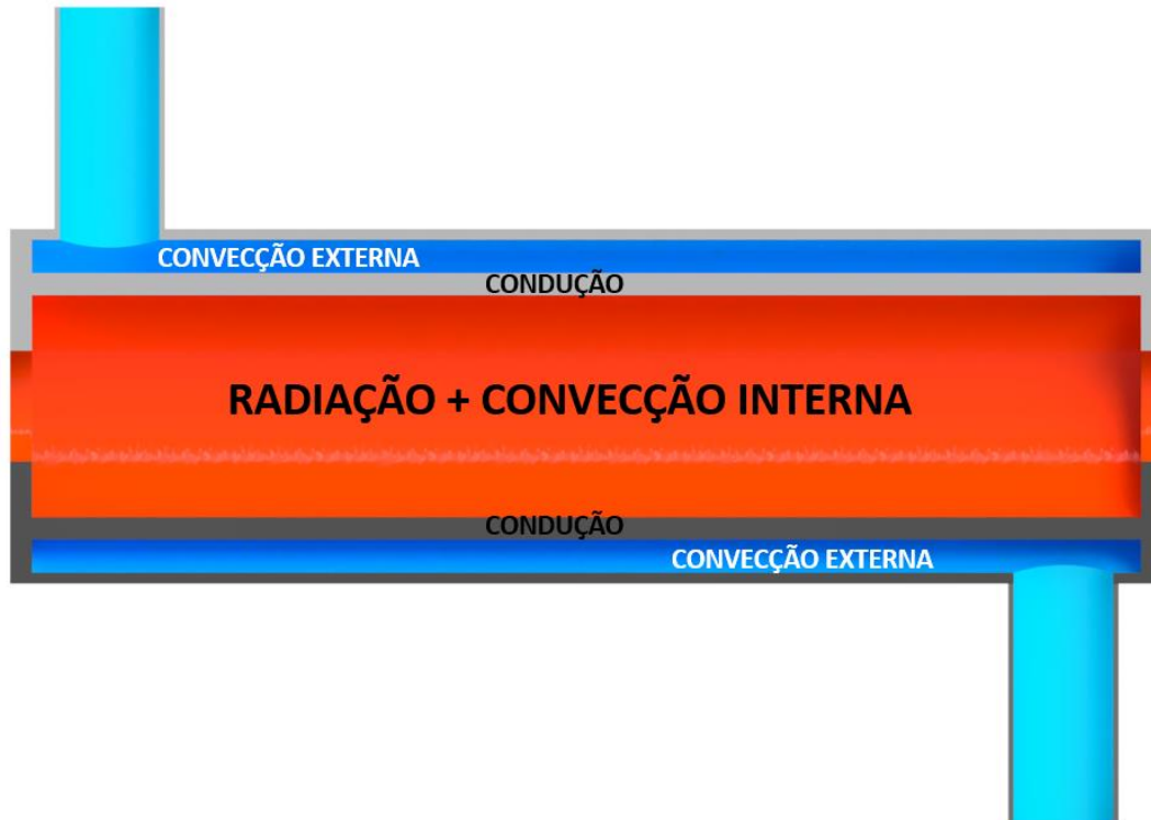
Figura 4 - Transferência de calor em uma fornalha simplificada com paredes d'água
