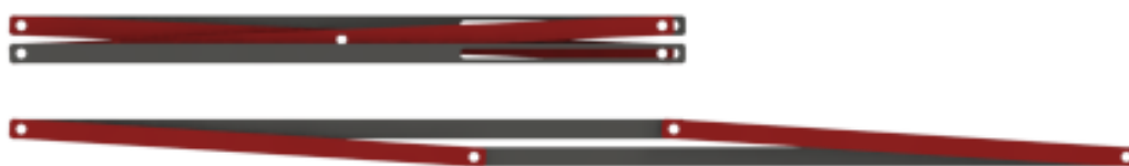
Figura 20 – Comparação dos mecanismos pantográfico e paralelogramo
