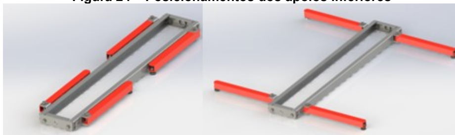
Figura 24 – Posicionamentos dos apoios inferiores
