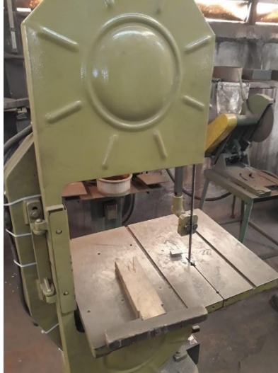
Figura 24 - Serra usada para corte das peças e análises de sanidade
