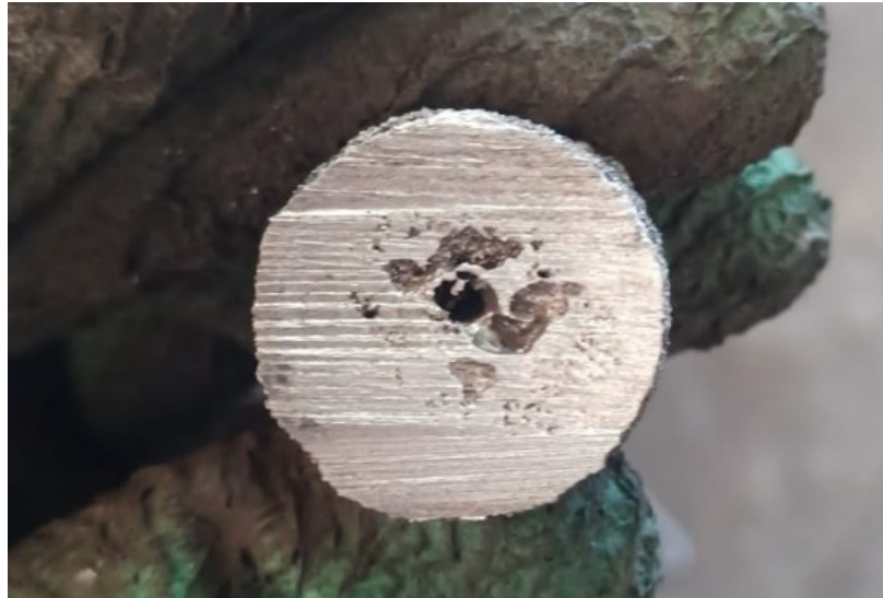
Figura 32 - Exemplo de rechupe frequentemente encontrado na base da luva
