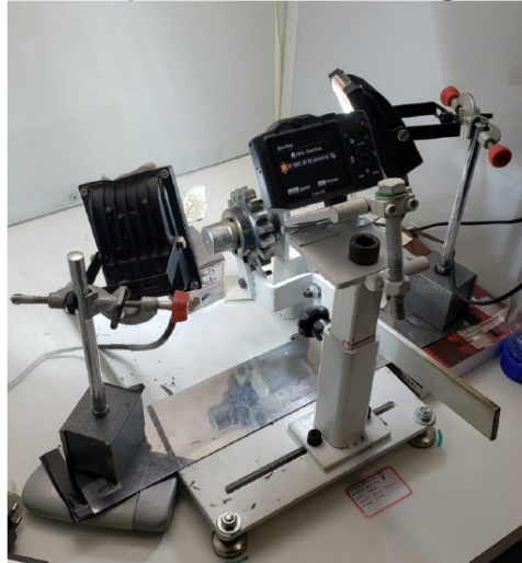
Figura 15: Bancada para realização da imagem com os furos
