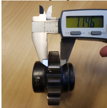
Figura 16: Paquímetro digital realizando leitura de medida de lado superior do dente da engrenagem
