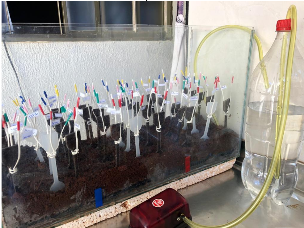
Figura 9 - Sistema de análise da biodegradação parcialmente preenchido com solo compostável
