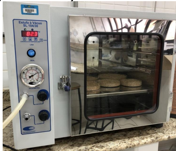
Figura 3 - Secagem da casca de soja em uma estufa a vácuo SL 104/30 da Solab
