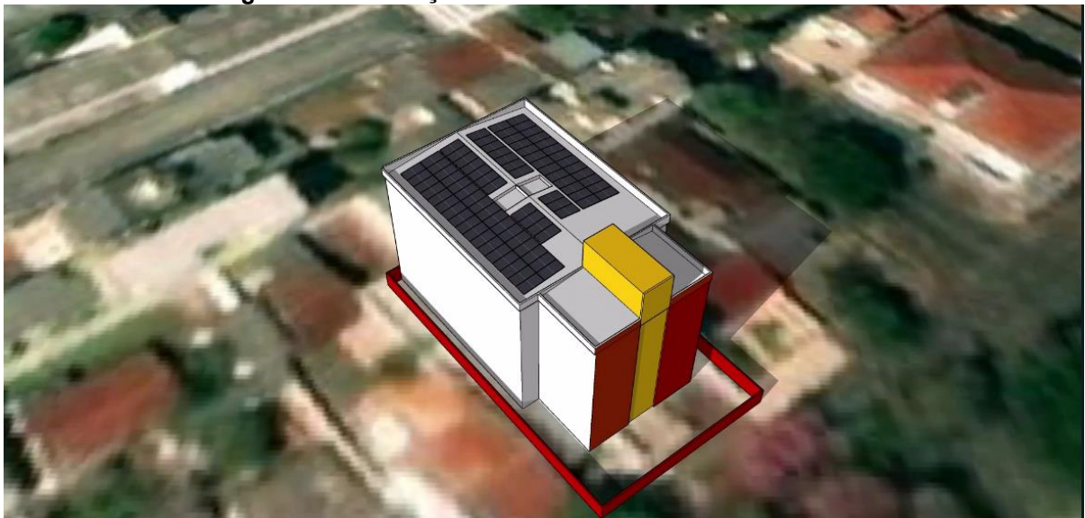
Figura 13 - Simulação do sistema fotovoltaico no edifício
