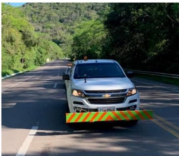
**Figura 2: perfilômetro utilizado na pesquisa
