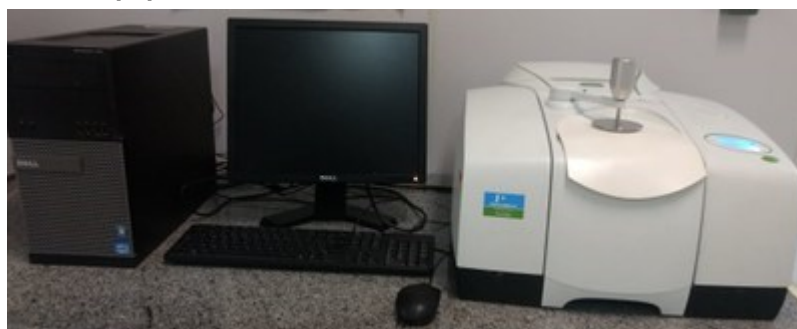
Figura 6 - Equipamento de FTIR-MIR, modelo Frontier, da Perkin Elmer
