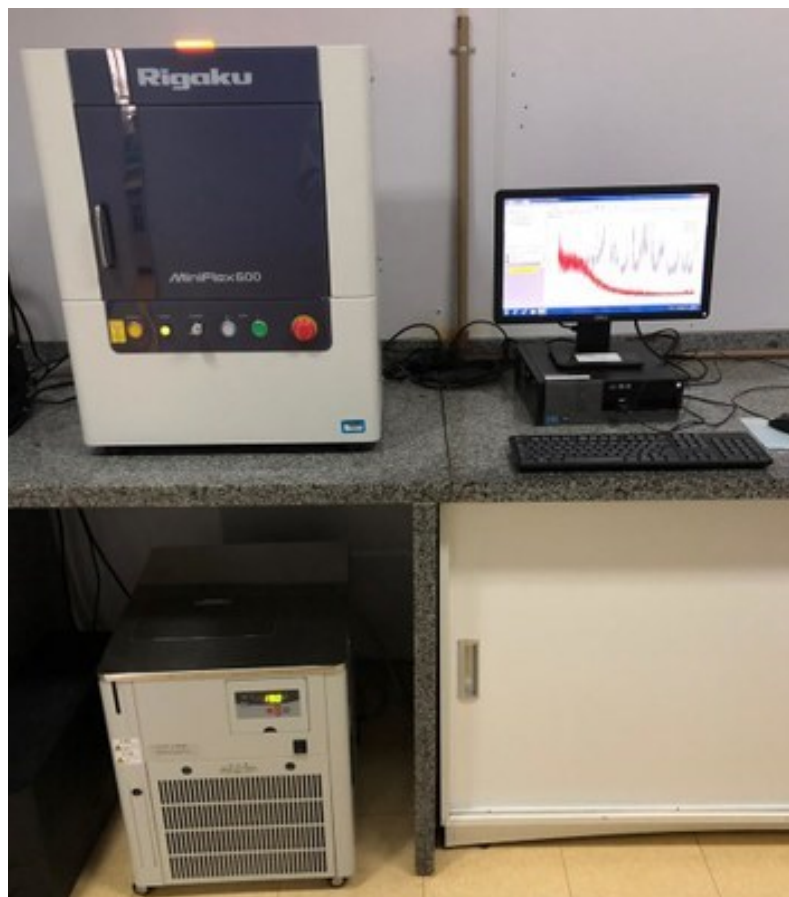
Figura 3 - Difratorômetro de Raios X (modelo Miniflex 600, Rigaku)
