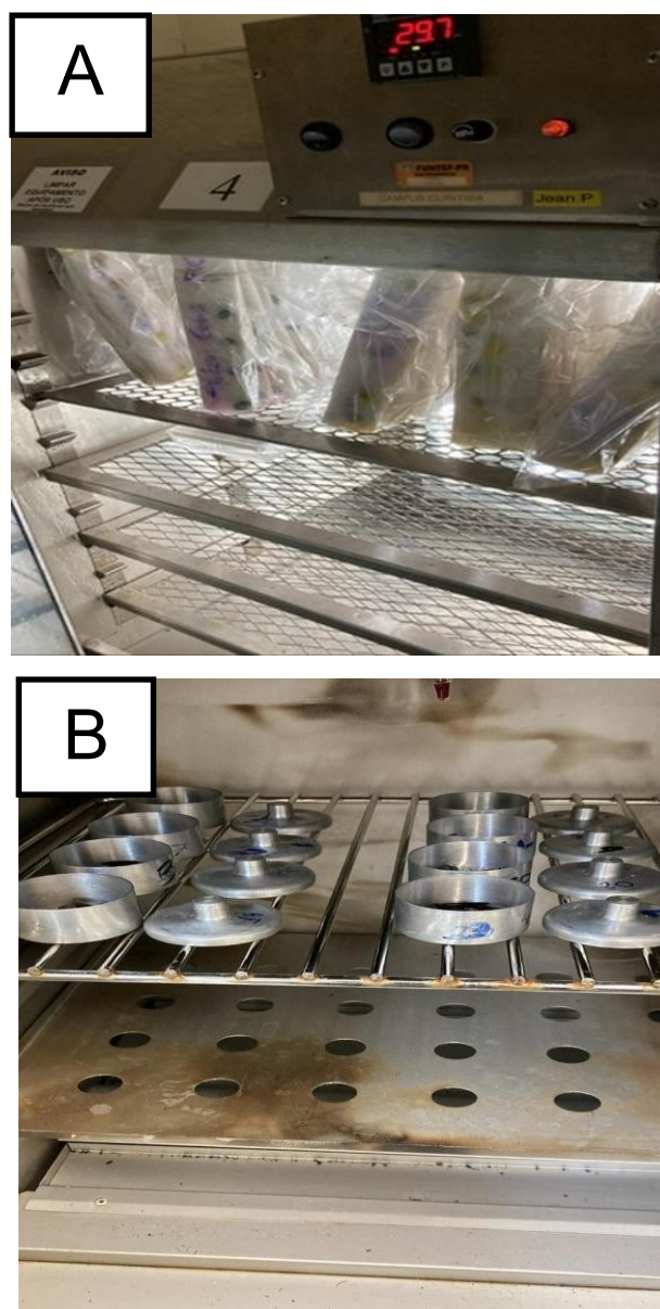
Figura 10: Testes após submetidas aos métodos gerbox e câmara de envelhecimento acelerado.
