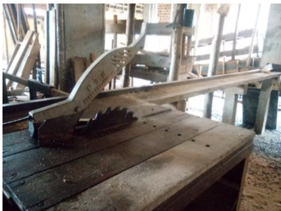
Figura 14 - Mesa de carpintaria da obra 2
