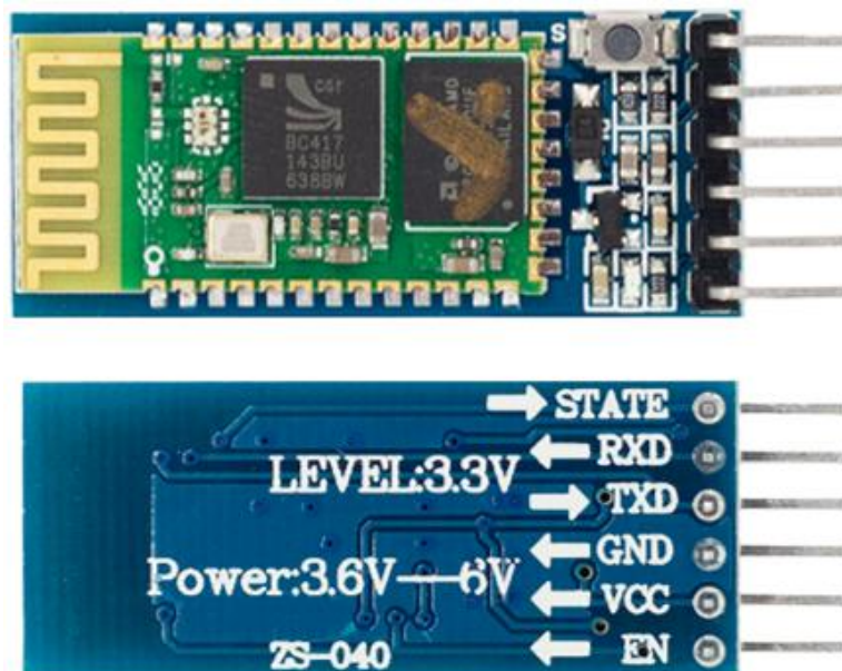
Figura 13 - Módulo Bluetooth HC05 frente e verso
