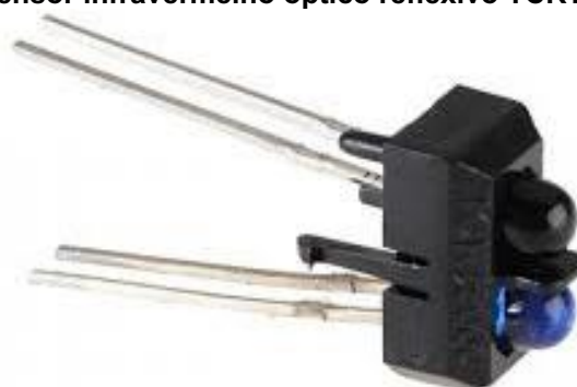
Figura 12 - Sensor infravermelho óptico reflexivo TCRT5000
