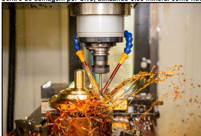
Figura 7 - Centro de usinagem por CNC, utilizando óleo mineral como fluido de corte
