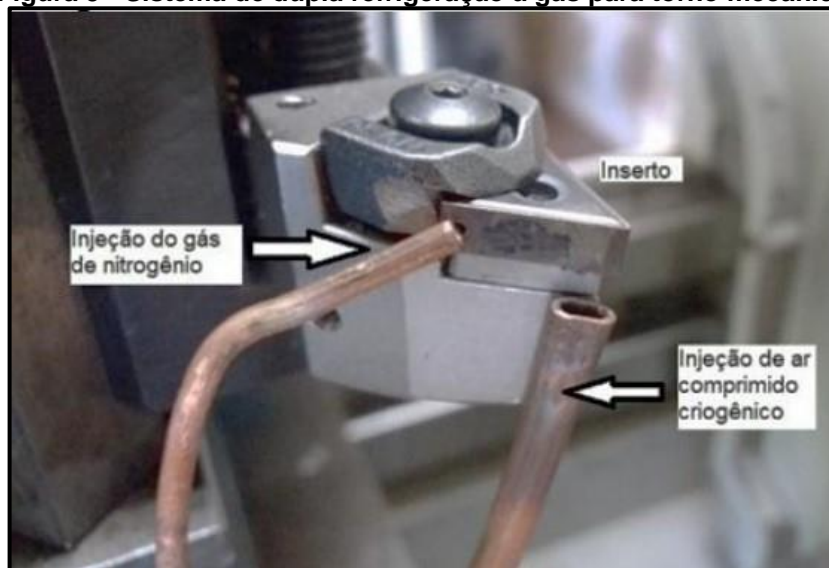
Figura 5 - Sistema de dupla refrigeração a gás para torno mecânico
