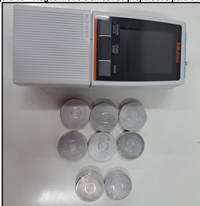
Figura 19 – Rugosímetro e amostras preparadas para o teste
