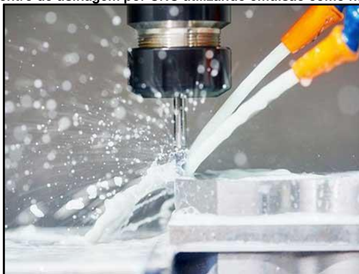
Figura 6 - Centro de usinagem por CNC utilizando emulsão como fluido de corte
