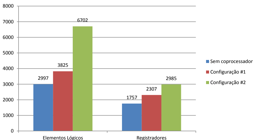
Figura 31 – Acréscimo de hardware devido à adição do coprocessador
