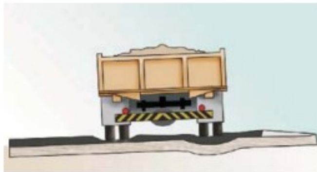
Figura 5. Deformação Permanente no pavimento
