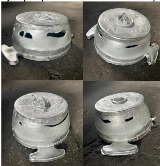
Figura 17 - Peças que apresentam falha no último terço/solidificação
