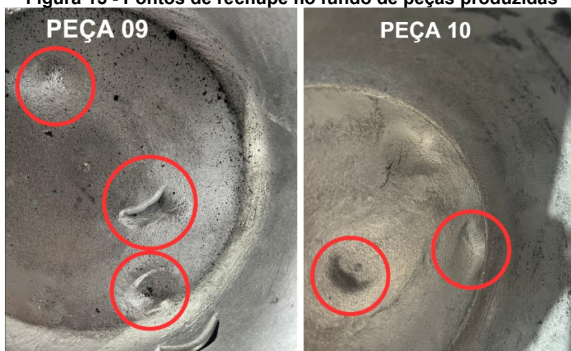
Figura 15 - Pontos de rechupe no fundo de peças produzidas
