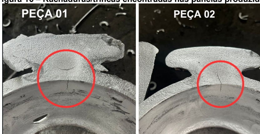
Figura 16 – Rachaduras/trincas encontradas nas peças produzidas
