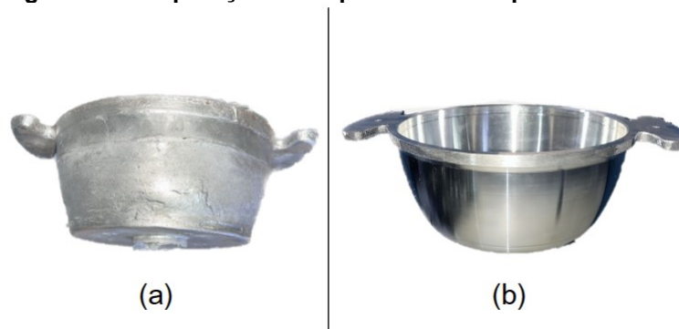
Figura 4 - Comparação entre panela bruta e panela acabada
