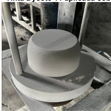
Figura 13 - Tinta Dycote 11 aplicada sobre o molde
