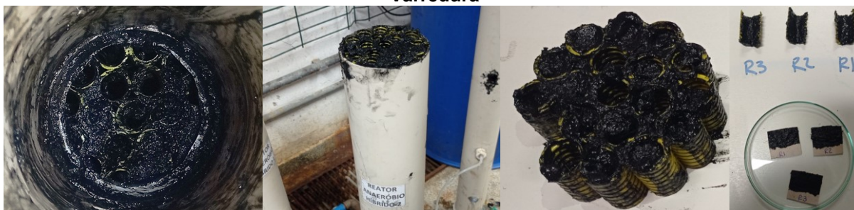
Figura 8 - Fotografia da coleta de amostras de lodo para análises de Microscopia Eletrônica de Varredura
