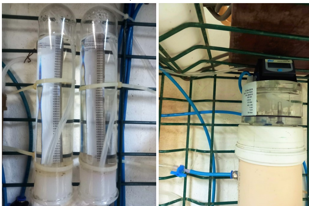
Figura 7 - Fotografia do sistema de medição de volume de gás: a) por deslocamento líquido e; b) Medidor Ritter
