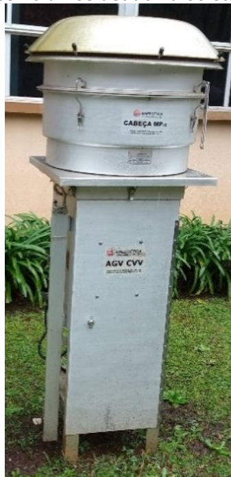
Figura 9: Amostrador de grandes volumes usado na coleta de material particulado (MP10).
