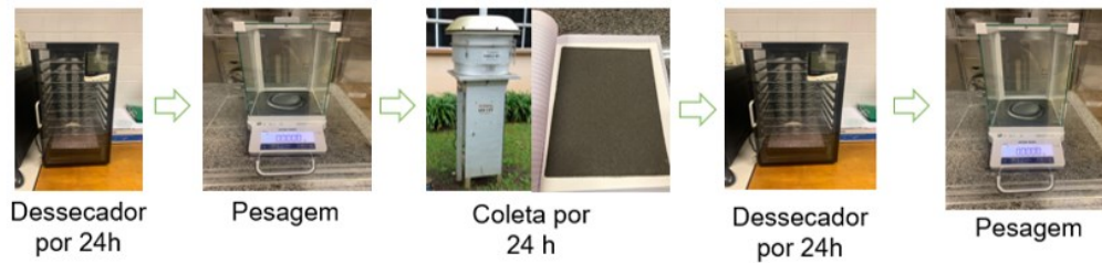
Figura 10: Etapas seguidas na coleta e determinação da concentração de material particulado (MP10).
