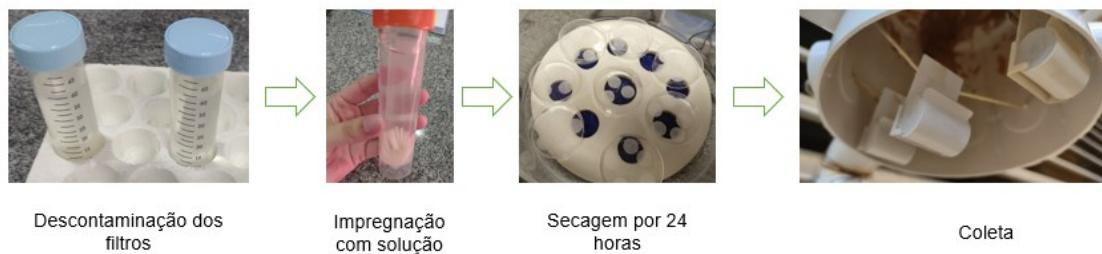
Figura 5: Etapas realizadas na impregnação dos filtros para coleta de NO 2 .
