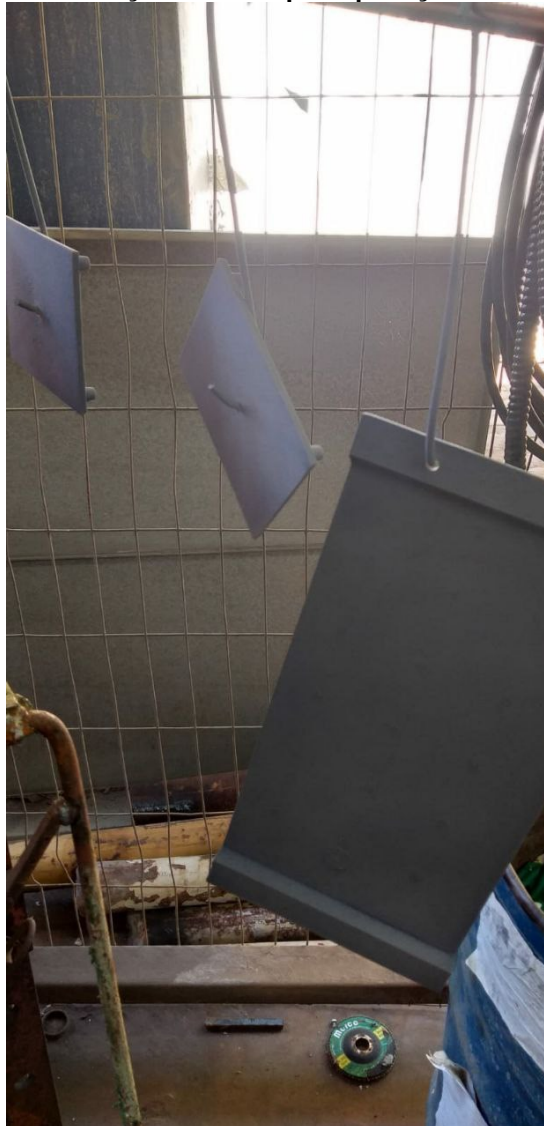
Figura 20 - Peças de teste pós aplicação do esmalte
