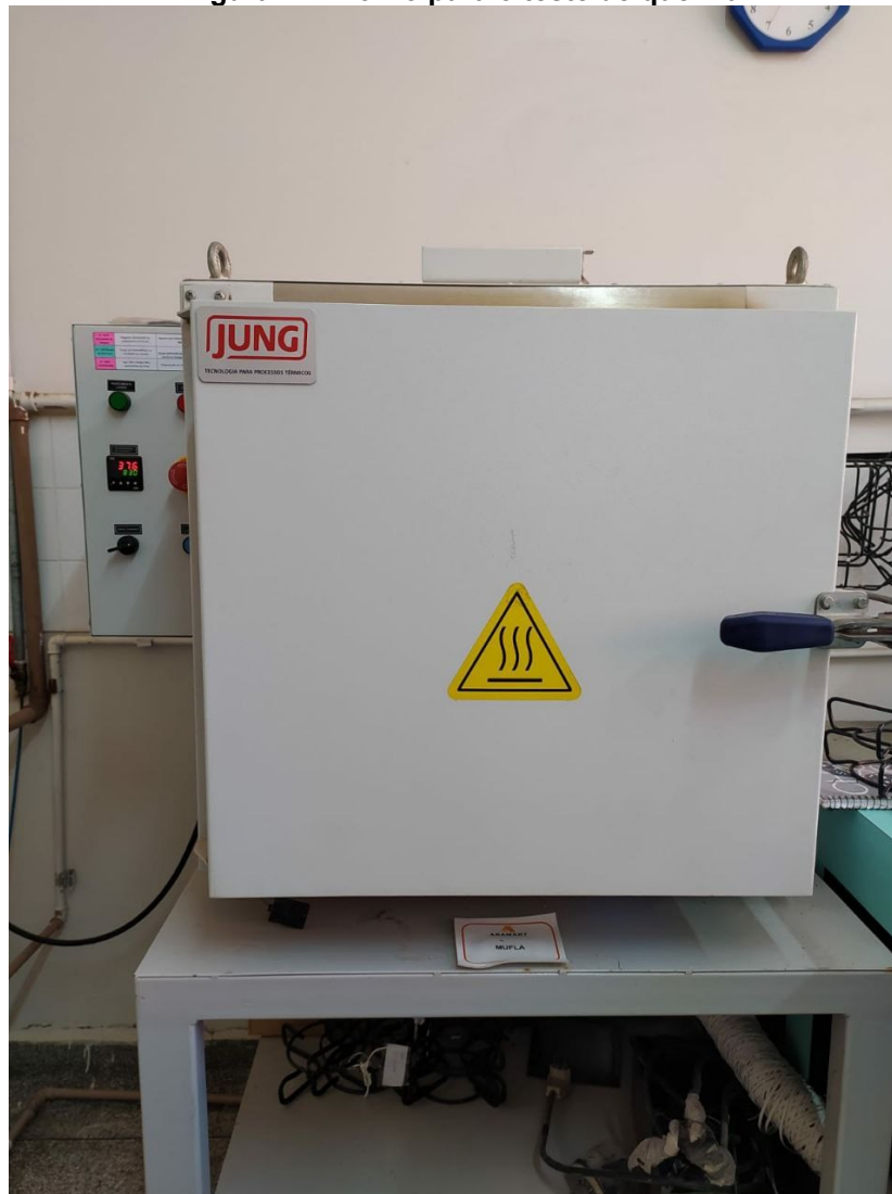
Figura 14 - Forno para o teste de queima
