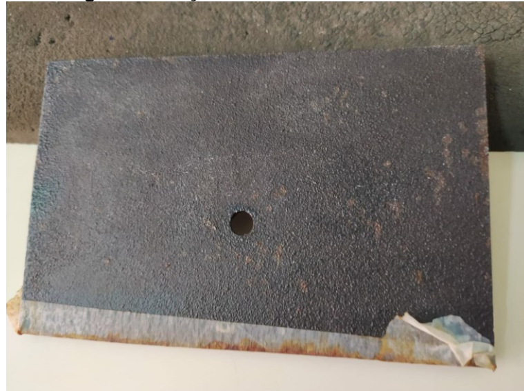
Figura 33 - Peça teste imersa em névoa salina
