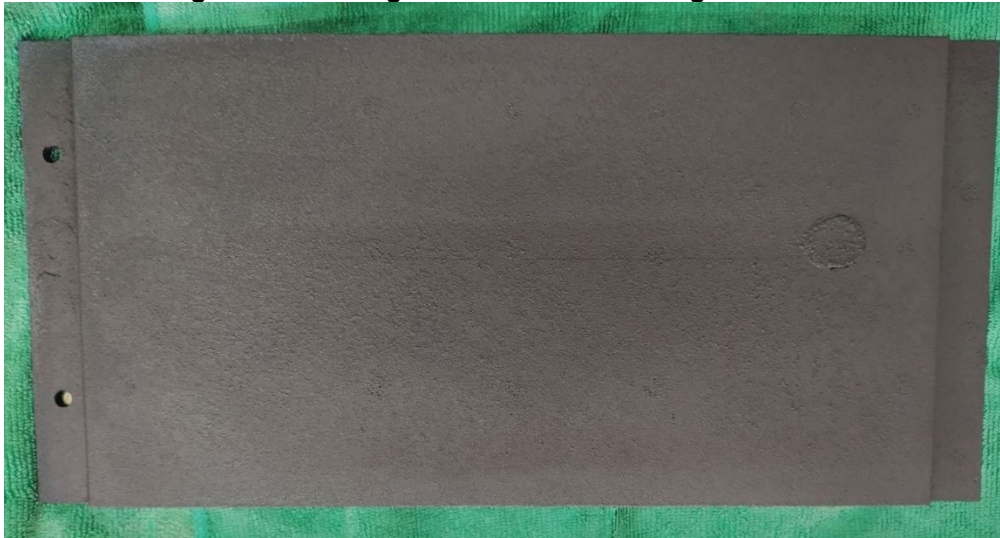
Figura 26 - Placa grande esmaltada no segundo teste
