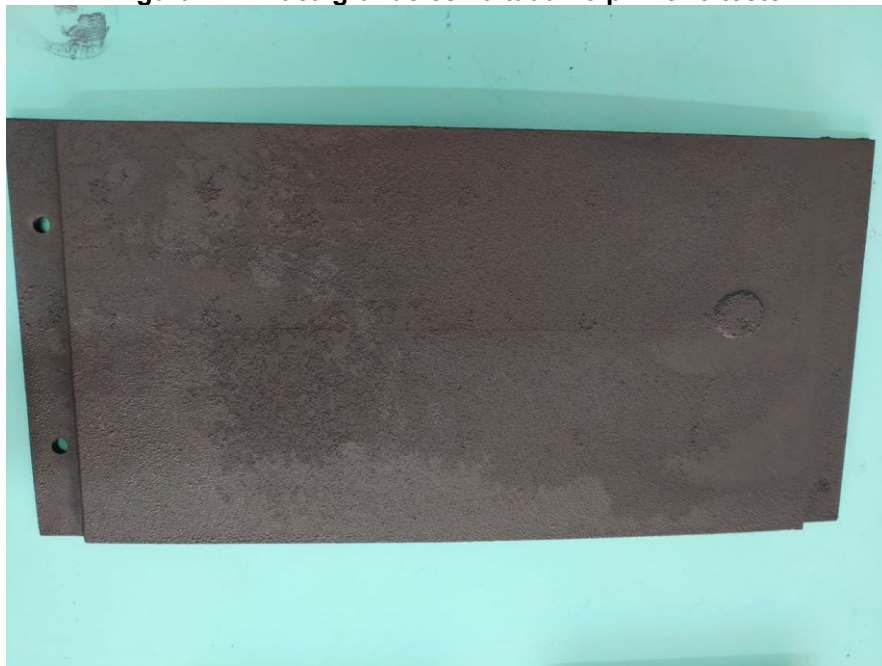
Figura 24 - Placa grande esmaltada no primeiro teste
