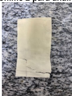
Figura 16 - Corpo de prova do biofilme 2 para análises das propriedades mecânicas
