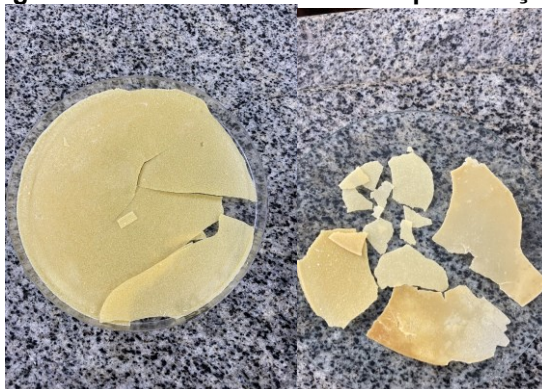
Figura 14 - Biofilmes com zonas quebradiças
