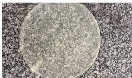
Figura 15 - Biofilmes PLA incorporado o soro de leite
